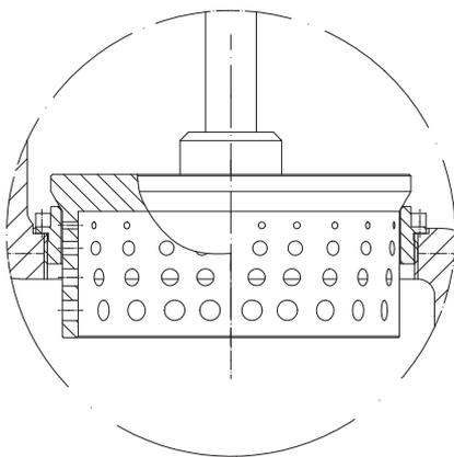
Рис. 3: перфорированный затвор
