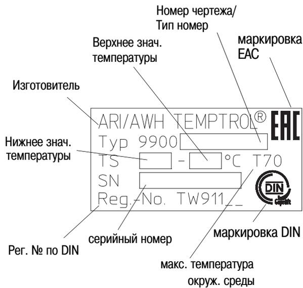
Рис. 3: Терморегулятор
