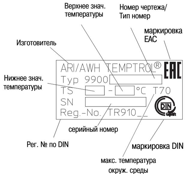
Рис. 4: Термореле
